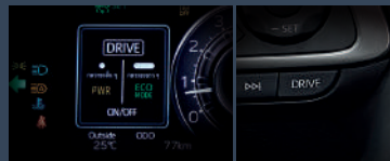
สวิตช์ปรับโหมดการขับเคลื่อนพวงมาลัย ได้ 3 แบบ ECO / NORMAL / POWER
